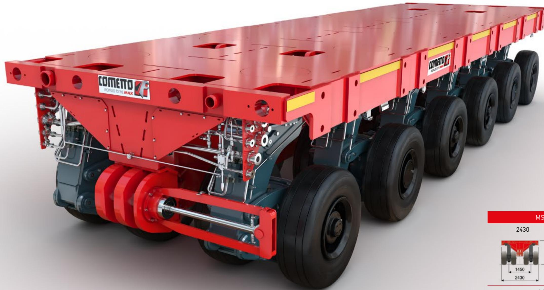
⊕ Модули EVO серии MSPE с нагрузкой на ось 60 т и 70 т имеют самую большую грузоподъемность на рынке.
